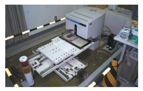
図2 走査型蛍光X線分析顕微鏡。俗称「5時からマシーン」。
