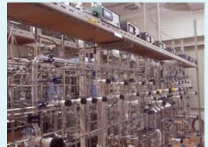
試料の不純物を取り除く二酸化炭素精製用真空ライン。
