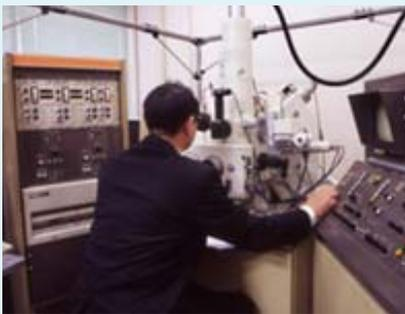
CHIME年代を測定する電子線マイクロアナライザ。
