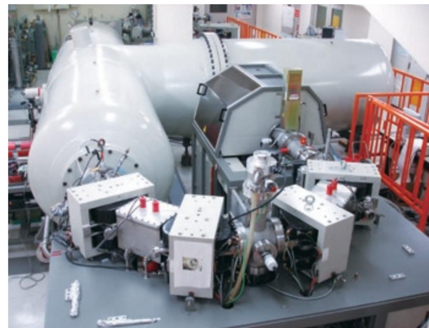
図1 タンデロン加速器質量分析装置
