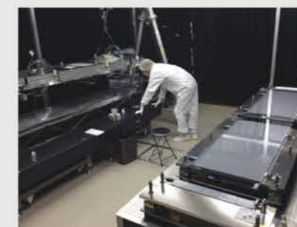
図4 組み立てを行ったクリーンルーム内の様子 右の台の上に石英ガラスが置かれており、左の台の上に、支持構造体と製作装置が設置してある。
