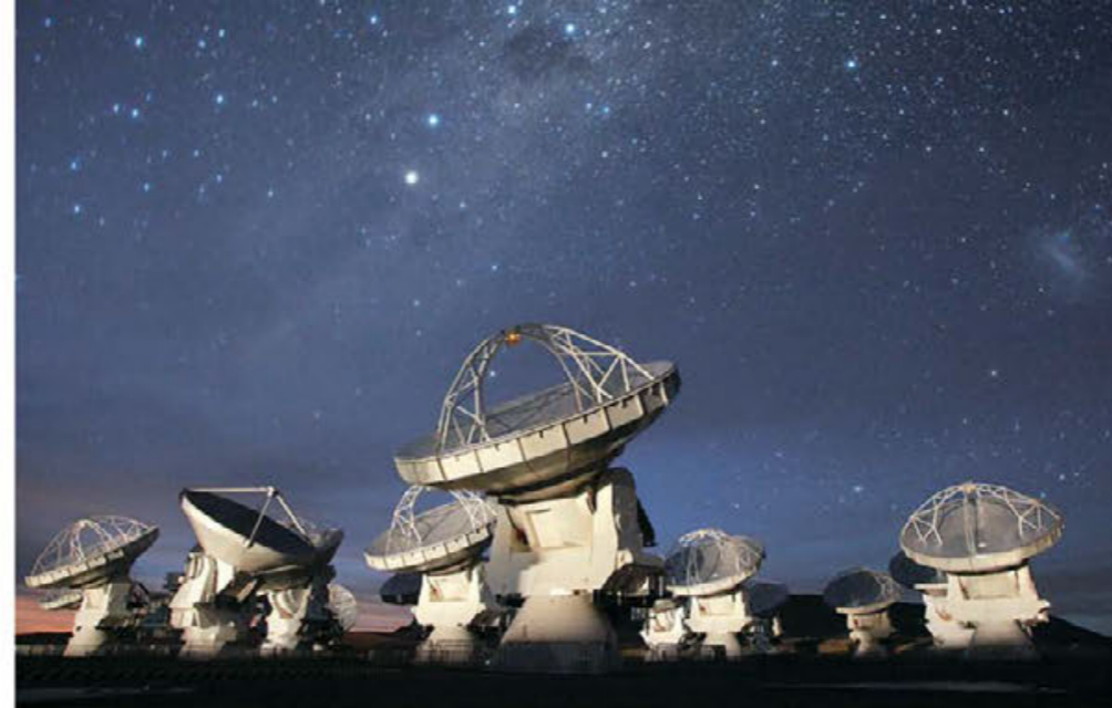
図1 標高5000mのチリ・アタカマ砂漠で観測するアルマ望遠鏡。口径12mのアンテナ54台と、口径7mのアンテナ12台からなる干渉計望遠鏡(Credit: ALMA Observatory)
