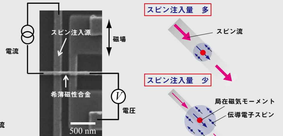
図2 スピン流計測デバイス
