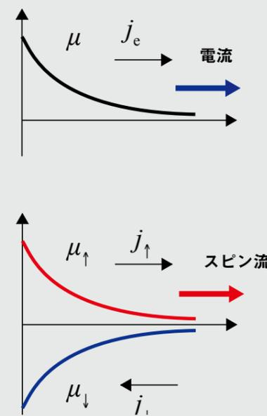
図1 伝導電子スピン流の生成
